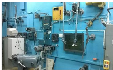
Зовнішній вигляд «гарячих камер» з дистанційним обладнанням
