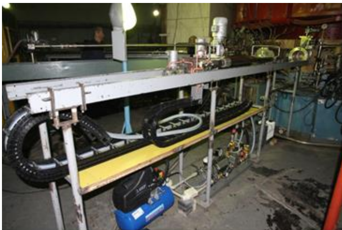
Технологічна установка для напрацювання радіонукліда ^{82}\text{Sr} на циклотроні У-240
