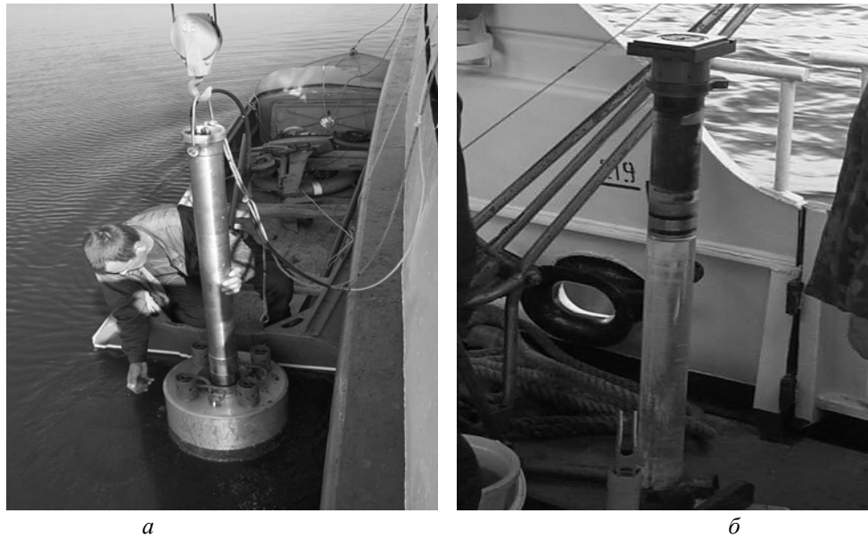
Рис. 3. Пневматичний пробовідбірник для мулових донних відкладів: а – занурення пробовідбірника у воду; б – поділ колонки відкладів на горизонтальні шари на гідравлічному екструдері.
