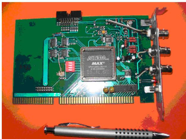
Рис. 3. Конструкция АЦП.
