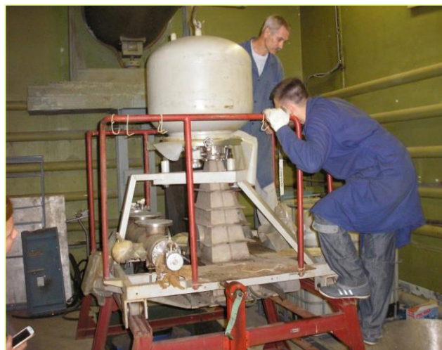
Рис. 10. Монтаж в ІЯД НАН України прискорювача 0,4 МеВ і потужністю пучка 20 кВт.
