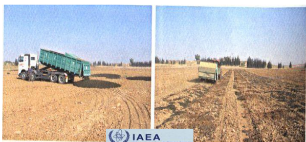
Рис. 5. Рекультивация пустелі опроміненими комунальними відстоями (Ізраїль).
