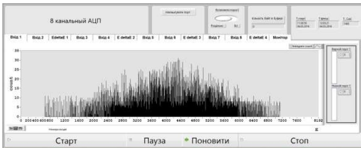
Рис. 5. Накопленный спектр в одном из входных каналов АЦП.
