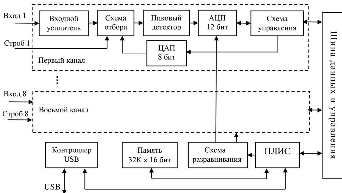
Рис. 1. Структурная схема АЦП.
