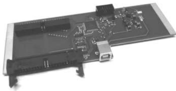
Рис. 3. Плата контроллера USB.
