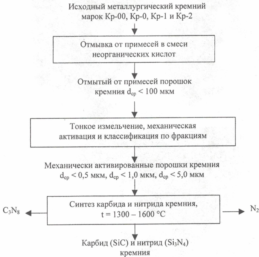
Рис. 2. Принципиальная технологическая схема производства по выпуску супертонких порошков карбида (SiC) и нитрида (Si 3 N 4 ) кремния.
