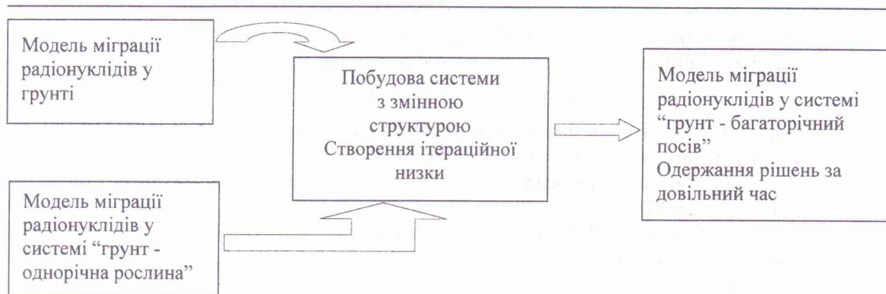
Рис. 1. Загальна схема взаємодії моделей, що дає змогу проводити розрахунки ефективності фітодезактиваційних технологій.
