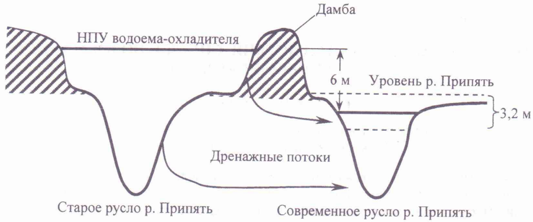
Рис. 1. Схема процессов фильтрации воды из водоема-охладителя ЧАЭС.
