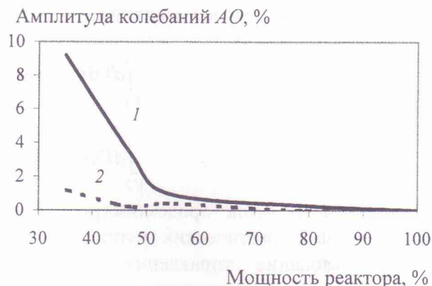
Рис. 1. Изменения амплитуды колебаний AO при разгрузке от номинальной мощности до указанной на графике (линия 1) и подъеме мощности от указанной на графике до номинальной (линия 2).
