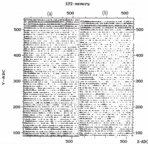
Рис. 5. Спектри pp -збігів з реакції p + d \rightarrow p + p + n для двох наборів кінематичних умов: \theta_1 = 30^\circ , \theta_2 = -42^\circ (а) і \theta_1 = 30^\circ , \theta_2 = -49^\circ (б).
