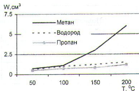
Рис. 2. Зависимость количества газовых продуктов радиолиза порошкообразного ПС от температуры.
